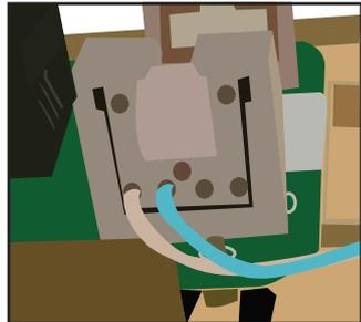
**IMPORTANT** : La connectique est auto-dénudante et s'effectue par basculement de l'excentrique
