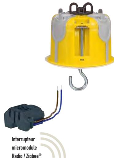
Positionné dans une boîte DCL, l'interrupteur micromodule Radio / Zigbee<sup>®</sup> (récepteur) est alimenté phase/neutre et donc adapté pour les lampes à économie d'énergie
