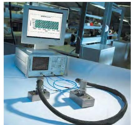
▲ MESURE DE L'IMPEDANCE DE TRANSFERT SUR BANC DE TYPE MICRO STRIP
